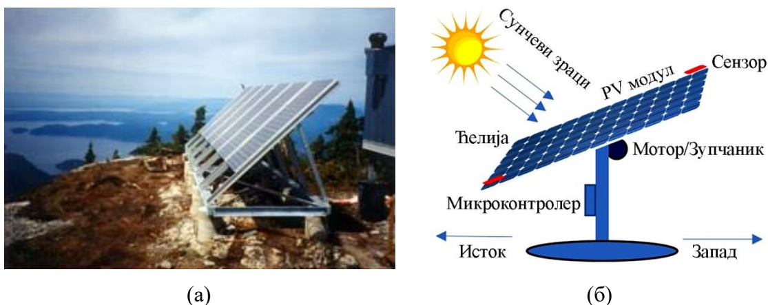
Слика 3.8 Генератор састављен од више PV модула (а) и основни делови (б)
