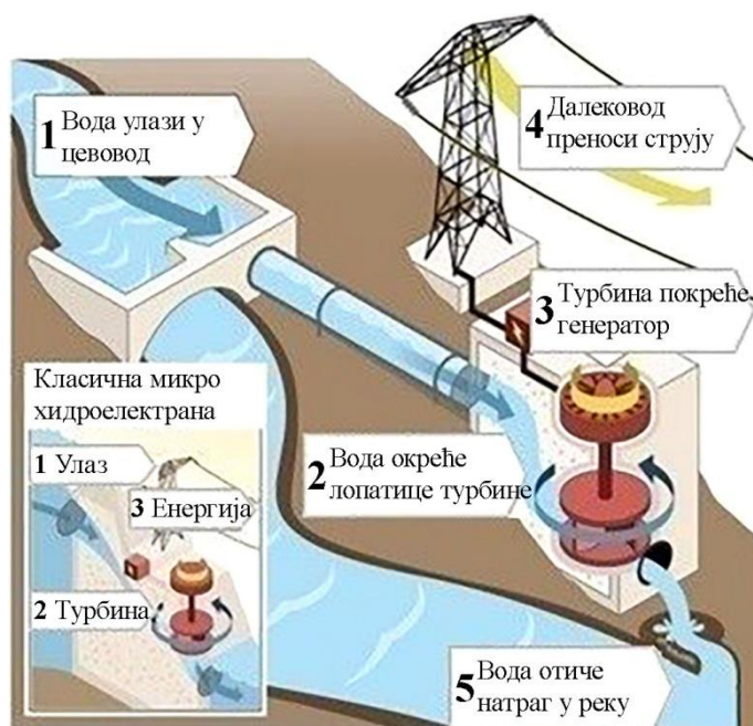
Слика 3.7 Проточна \mu ХЕ и њени основни делови
