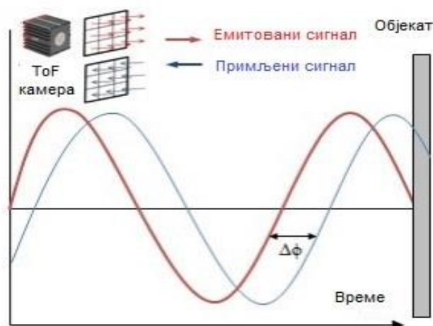
Слика 6.12 Ласерски пулсни ( Time of Flight ) скенери [109]
