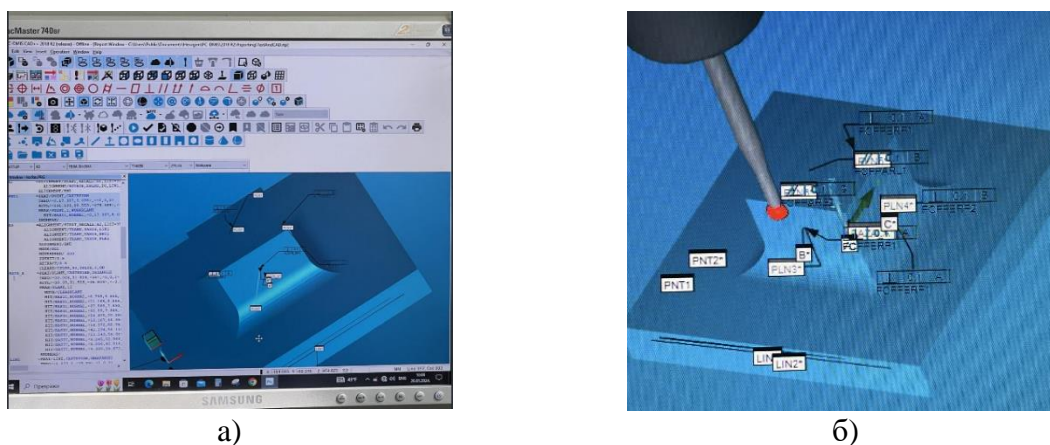
Слика 11.41 План мерења по мерној равни у софтверу мерне машине TESA-REFLEX recorder application software (а) и план мерења тачака мерених површина (б)
