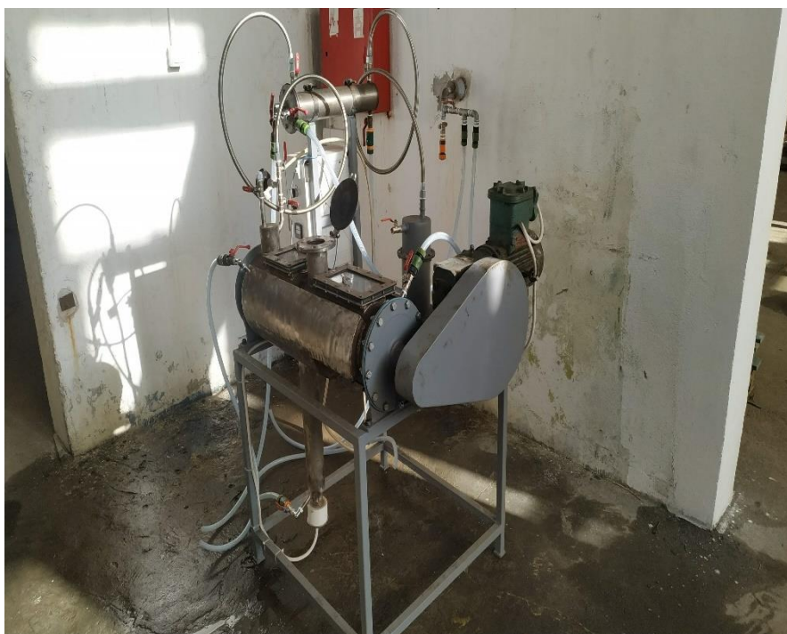
Слика 31. Изглед реактора за експерименте оптимизације синтезе алкалних алкилксантата по иновативном поступку
