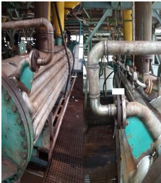
Слика 30. Изглед реактора за синтезу алкалних алкилксантата „Малаксер“
