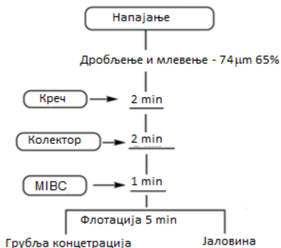
Слика 23. Дијаграм тока и услови испитивања флотације Bench-scale
