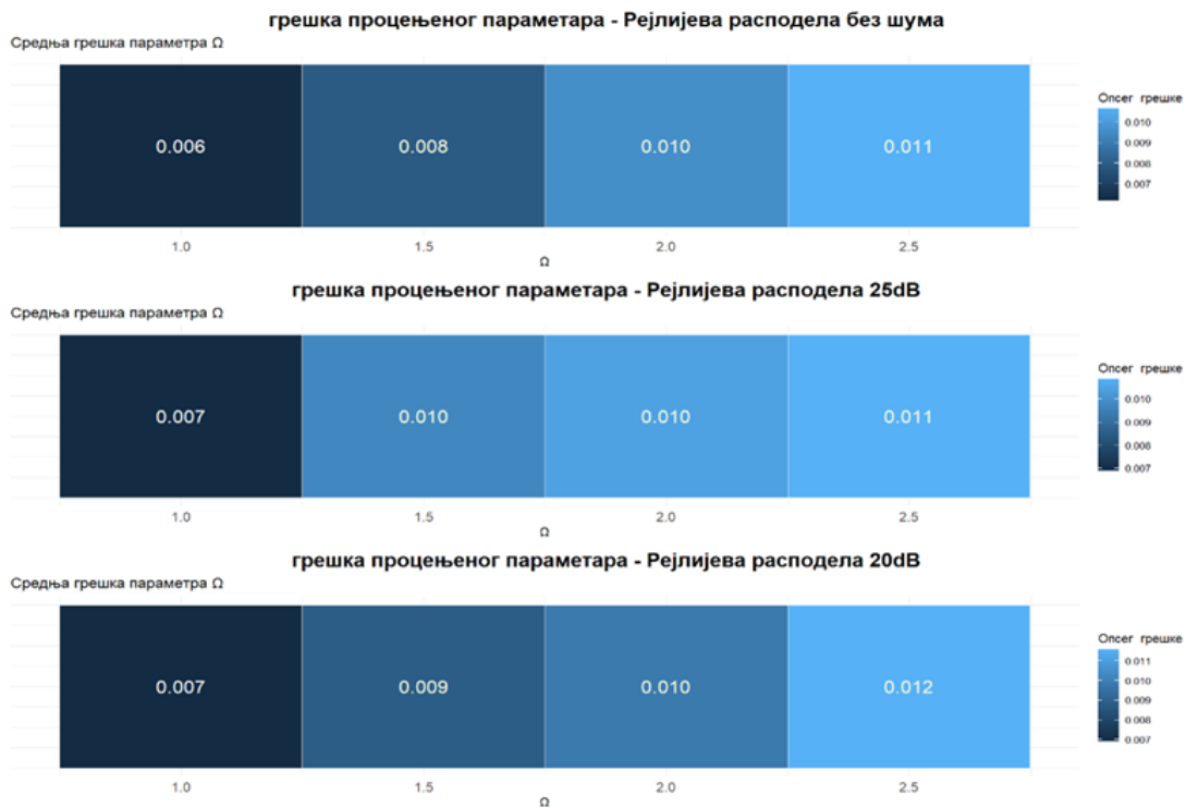
Слика 21. Топлотна мапа грешака процењених вредности параметара Рејлијеве расподеле код сигнала без шума, са SNR=25dB, и са SNR=20dB
