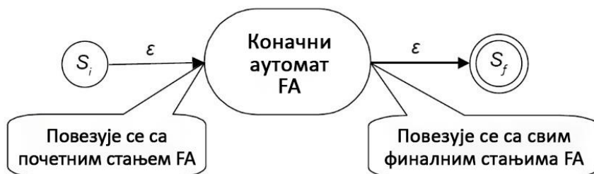
Слика 12. Додавање новог иницијалног S_i и новог финалног стања S_f
