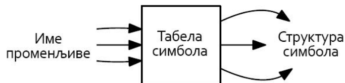
Слика 27. Табела симбола мапира име променљиве са припадајућом структуром симбола
